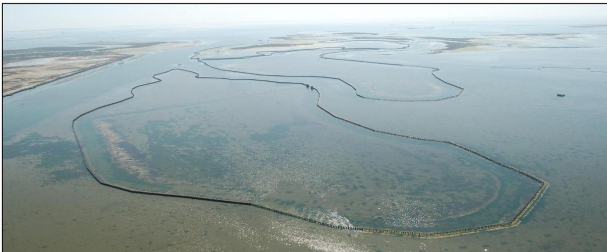
Figura 2. Refluimento diretto del sedimento proveniente dalla draga (Barena Palude Burano Sud).
