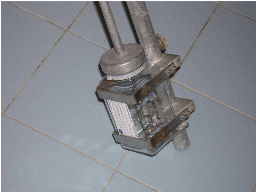
**Figura 3. Campionatore “grab” utilizzato per la raccolta dei campioni d’acqua per le analisi microbiologiche. Il campionatore per i metalli opera con lo stesso principio, ma è interamente in materiale plastico.**
