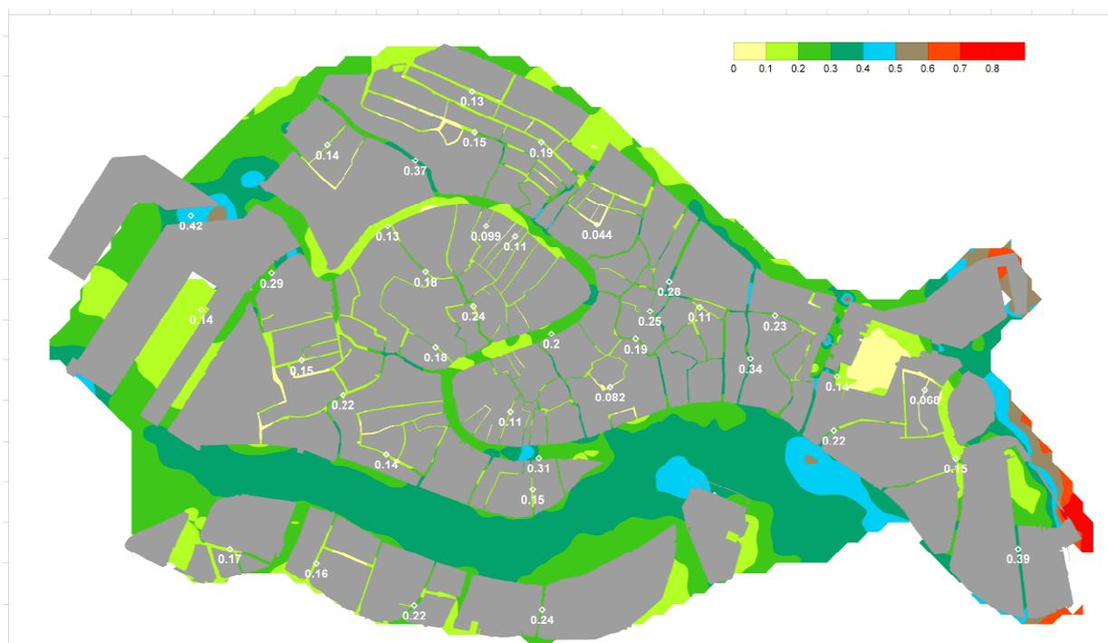
**Figura 9. Mappa delle velocità massime di corrente durante un ciclo di marea simulato con il modello dispersivo. I valori numerici (m/s) indicano il valore di velocità massima nei punti di campionamento del presente studio.**
